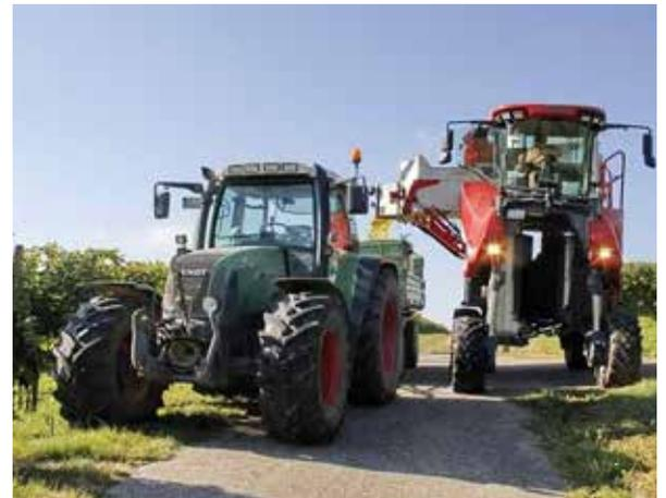
Auf dem Bild kannst du erkennen, wie schmal und hoch der Traubenvollernter im Vergleich zum Traktor ist. Dadurch kann er sich gut zwischen die engen Reben zwängen.
